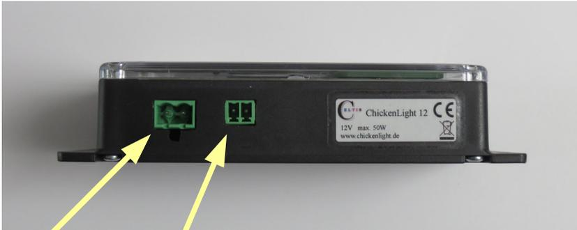
Am linken, größeren Steckverbinder wird die Spannungsversorgung angeschlossen.
