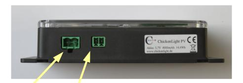
Am linken, größerer. Steckverbinder wird das Photovoltaikmodul angeschlossen.
