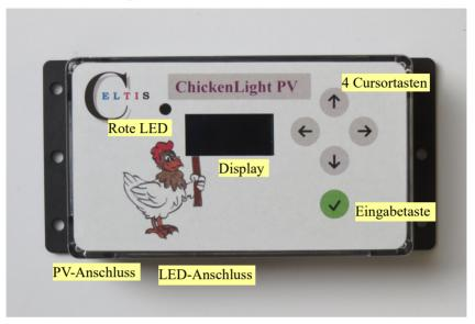
Die Steuerung besteht aus einem nahezu staubdichten Kunststoffgehäuse mit einem Display, 5 Touch-Tasten und einer roten Status-Leuchtdiode.
